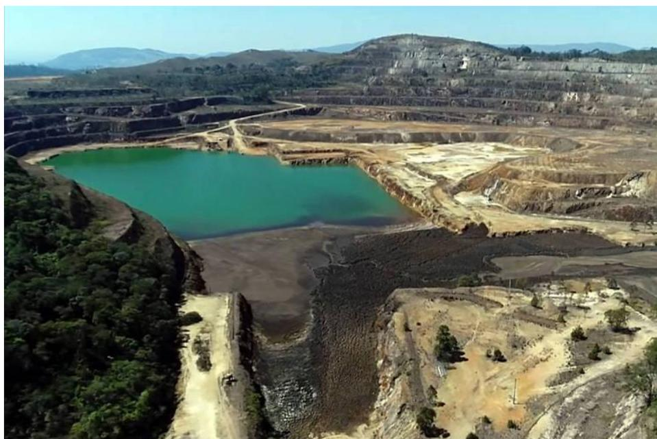
**Figura 10** - Cava da mina se torna imensa lagoa ácida **Fonte:** Boletim ClimaInfo (2019, online<sup>15</sup>).
